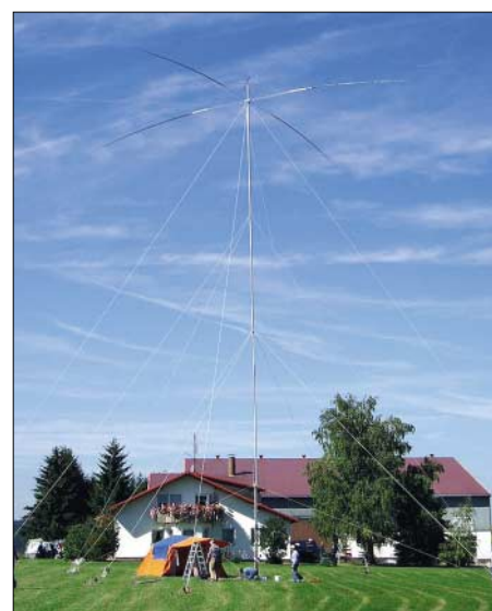
Die 24 m hohe Langwellenantenne Foto: DK1SB
