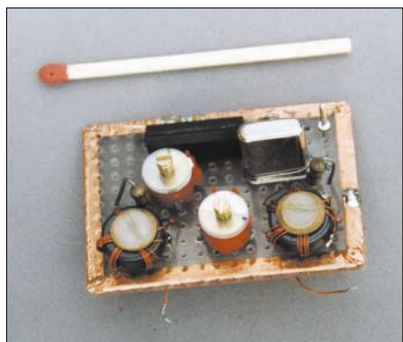
Bild 2: Das einfache Filter gemäß Bild 1 lässt sich relativ klein aufbauen.
