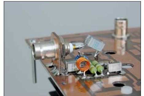
Bild 7: Eingangseite des Messaufbaus gemäß Bild 2, hier mit Parallelkompensation und Schutzbeschaltung
