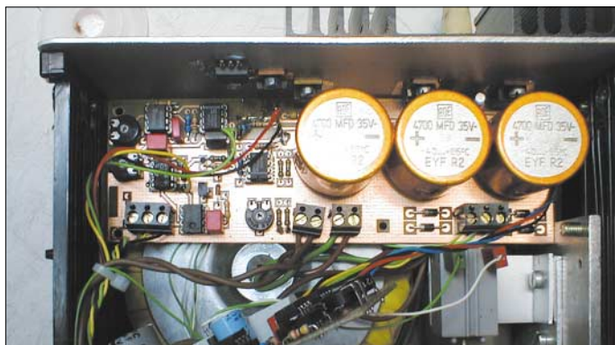
Bild 1: Die Temperaturregelung lässt sich eigenständig betreiben oder z.B. zusammen mit einer Luftpumpe für HeißluftlötKolben in ein Gehäuse integrieren. Zur besseren Darstellung wurde die Pumpensteuerung zeitweise demontiert.
