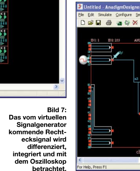
Bild 7: Das vom virtuellen Signalgenerator kommende Rechtecksignal wird differenziert, integriert und mit dem Oszilloskop betrachtet.
